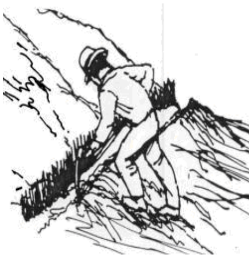
Figura 4.23. Forma en que se siembran la barrera viva en grupos de a dos
